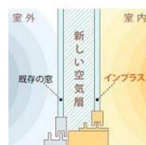
外部とインプラスの間隔（中間空気層）が防音・断熱効果を発揮します。
